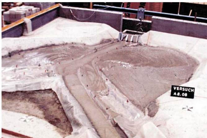
Ein simulierter Murgang im Modell der VAW
